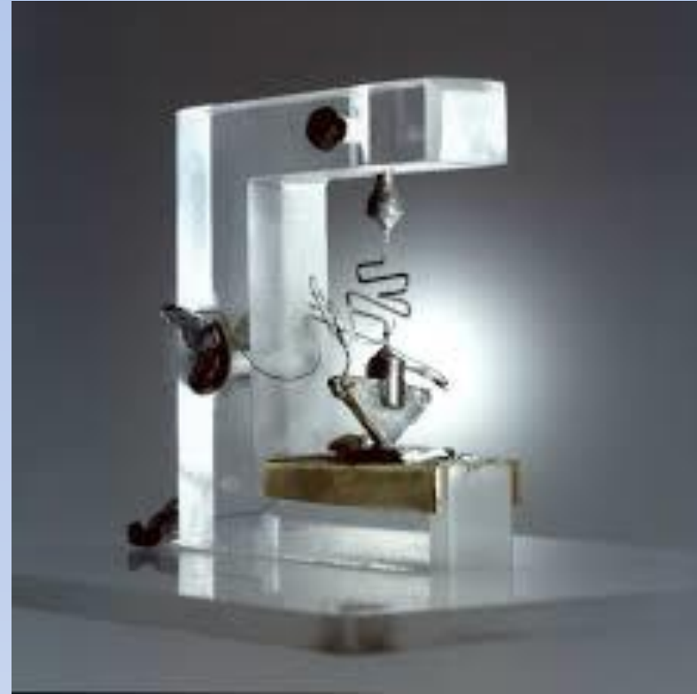
1 er transistor à semiconducteur (cristal Germanium)
